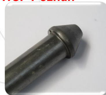
Wdrożenie: Zakuwanie końcówki przewodu paliwowego do silników
