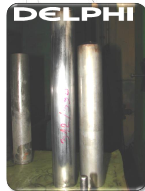
Wdrożenie: Obudowa amortyzatora o zmiennej grubości ścianki DELPHI Polska
